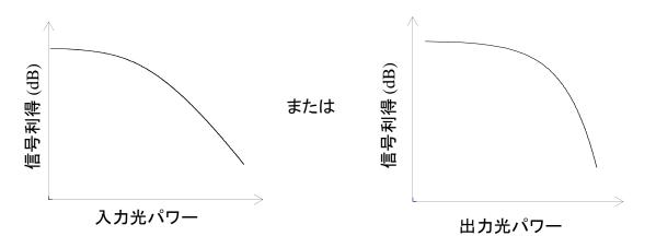
入力光パワーを上げていくと、出力光パワーが頭打ちとなる。 つまり、光増幅器からの出力光パワーには限界がある。
