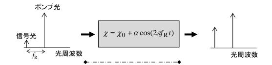
以上は一般的な話。このラマン散乱/ラマン増幅は光ファイバでも起こる。ファイバ・ラマン増幅器なお、ガラス媒質の光学フォノン周波数は約130THz、波長差にすると約100nm(@1.5mm帯)。
