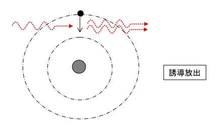
入射光からみたら、これは光増幅。これが光増幅器の基本原理。 なお、これらのエネルギー変換過程は確率的に起こる。 光増幅作用を得るためには、物質系が高いエネルギー状態にあることが必要。
