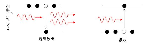
誘導放出確率は、上準位にある原子数に比例。また、入射光に刺激されて起こるので、 光 強度に比例: (誘導放出確率) ∞ (上準位数) × (光強度)
