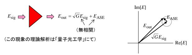
ASE光の振幅が大きいほど揺らぎも大きい。なので、ASEの出力光強度(またはパワー)が増幅器の雑音性能を表す指標となる。
