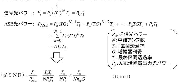
中継段数に比例して光SNは劣化 → 伝送距離制限
